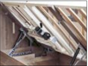
Elektrisch verstellbares Kopfteil (Serienmäßig im Imperial LT und LQB). Bei dieser Option verringert sich die Garagenhöhe um 10 cm.
